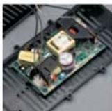
Elektrický napájecí zdroj
